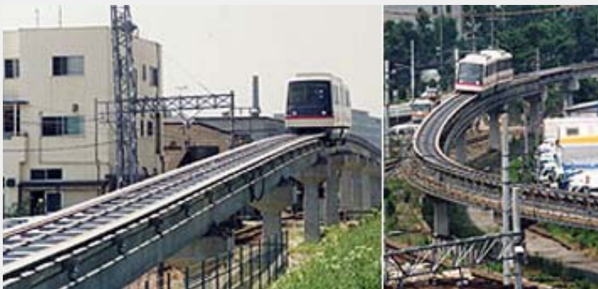
[그림2-8 급경사와 급커브를 운행하는 자기부상열차]
