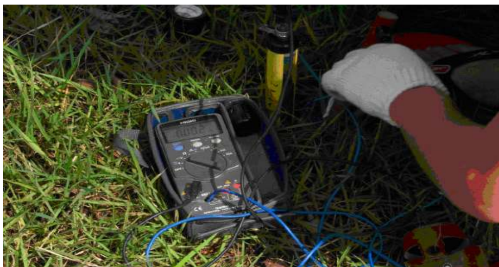
그림 B.2 - 관대지전위차 측정예시
