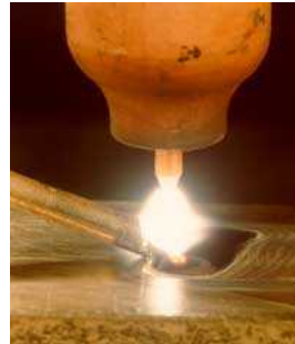
<그림 2-6> TIG용접의 원리도 및 용접 사진
