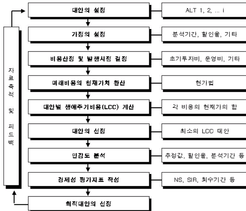
<그림 1-3> 생애주기비용(LCC) 시뮬레이션의 업무 흐름도
